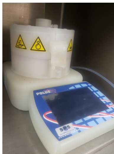
Figura 14: Spin coater POLOS empleado para elaborar la película delgada de Eritrosina B/PVA
