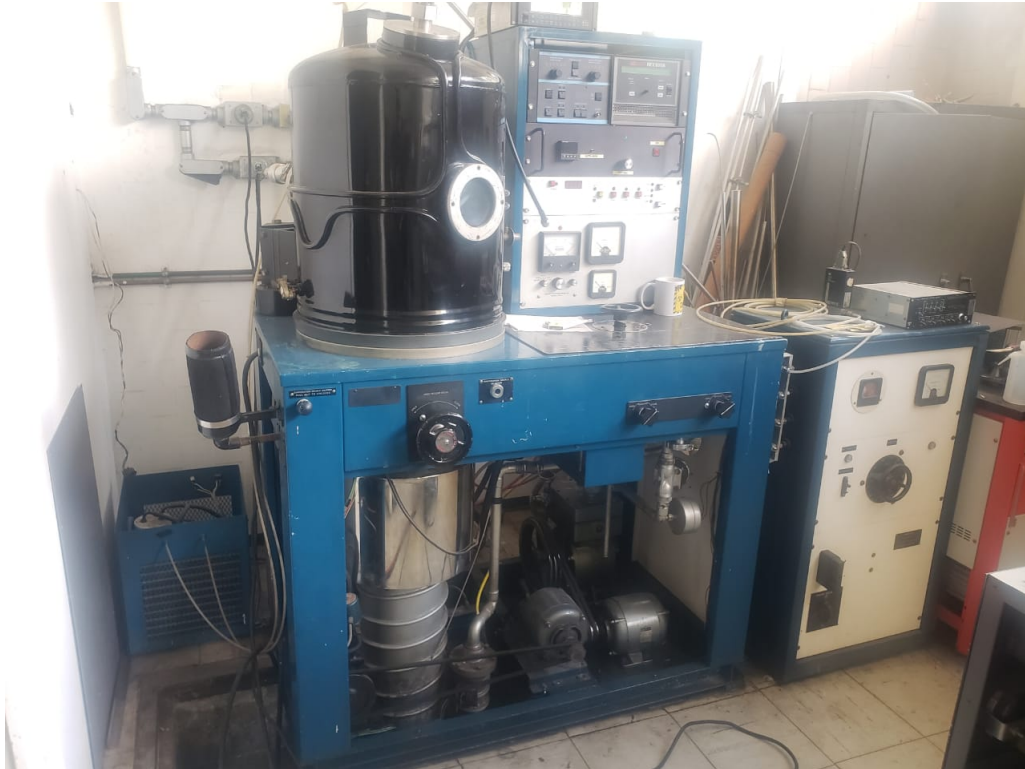
Figura 15: Equipo de Magnetron Sputtering fabricado en el IIM.
